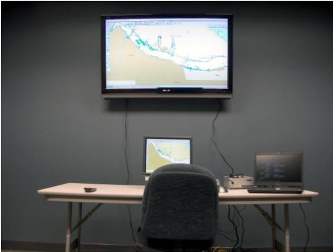
mit einer integrierten Trackingkomponente. Diese liefert genaueste Daten über die Entfernung und Geschwindigkeit aller Objekte die sich auf dem Fluss befinden. Die Radardaten werden momentan über eine DSL Leitung in das Gebäude der Georgia Tech übertragen und auf dem VTS-Display dargestellt.
